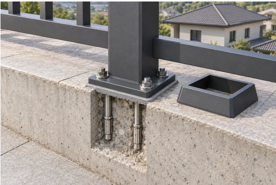
AI构造示意 · 栏杆立柱底部连接
