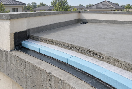
AI构造示意 · 屋面保温与保护层
